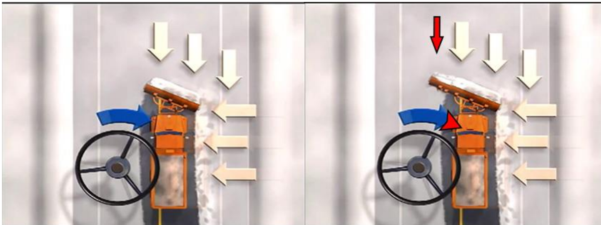
Figur 6 Asymmetrisk belastning øger behov for kontraststyring ved snerydning
